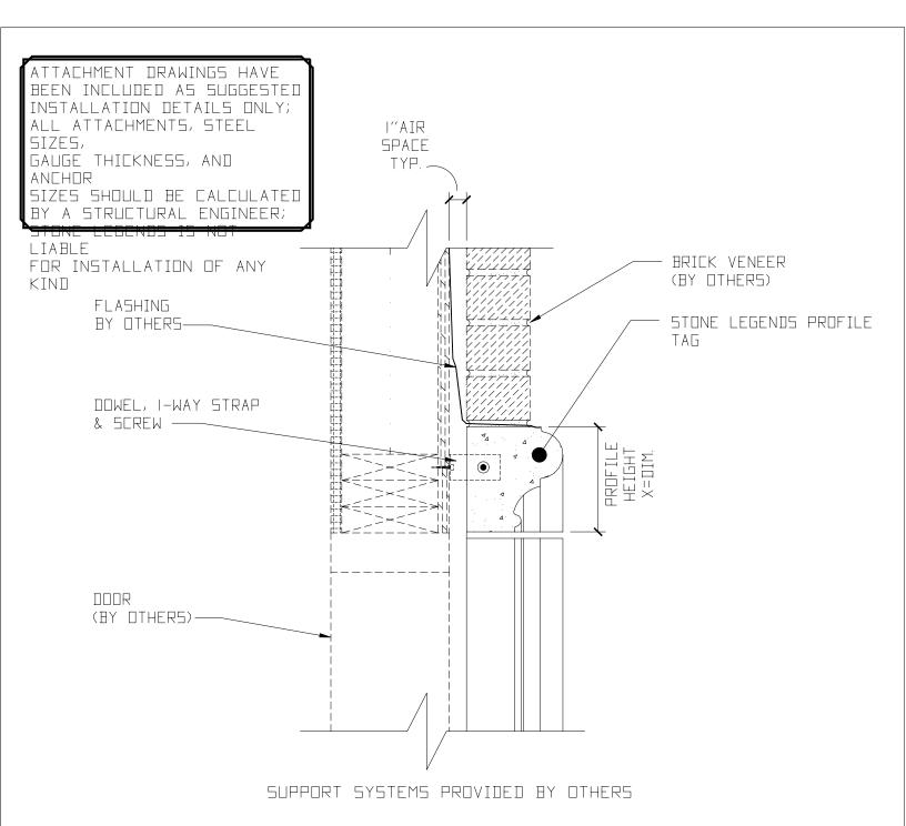
ATTACHMENT OF DOOR SURROUND TO WOOD STRUCTURE WITH FLASHING & DOWEL & I-WAY STRAP & SCREW
